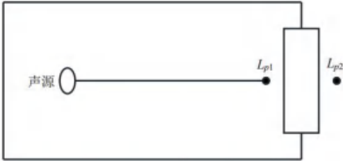
图 3 室内声源等效为室外声源图例
