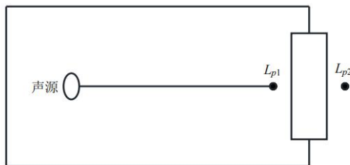
图 4-1 室内声源等效为室外声源图例
