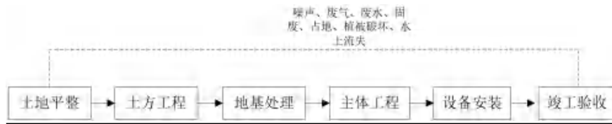
图 3.3-1 提灌站、蓄水池施工工艺流程图
