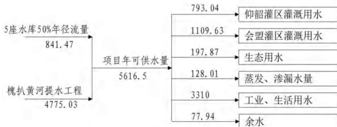
图 6.1-1 项目总水量水平平衡图
