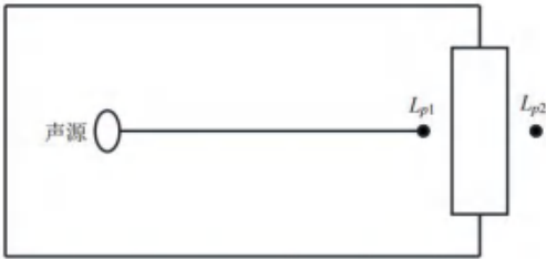
图3 室内声源等效为室外声源图例
