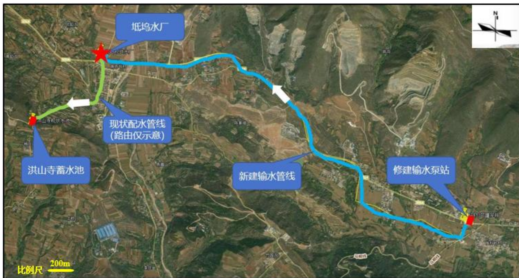
附图 10 坨坞水厂改造工程管线布置
