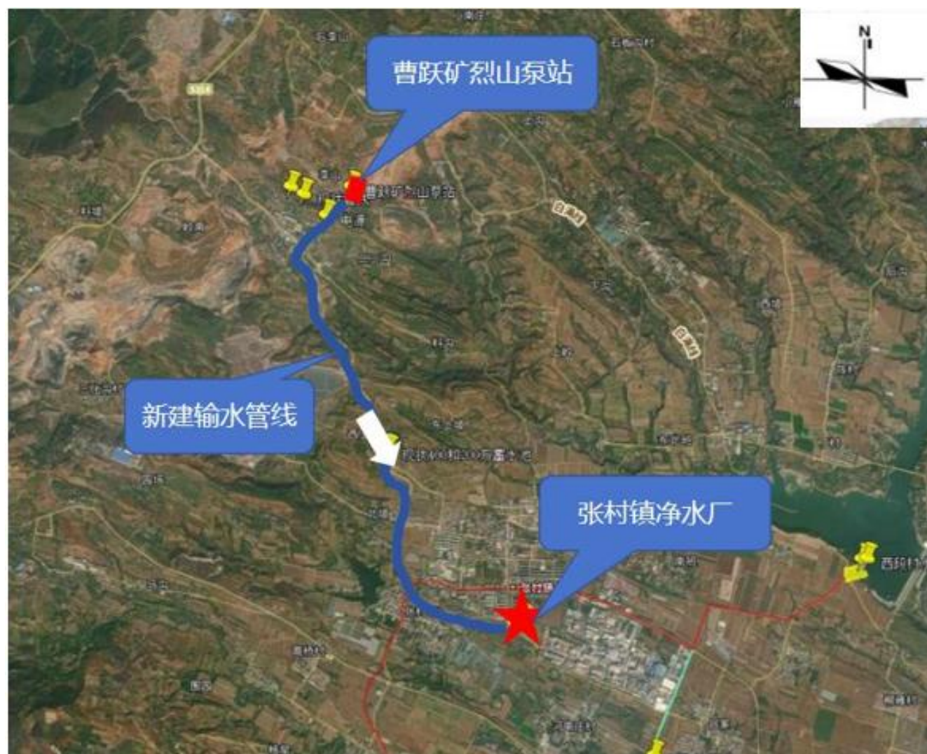
附图 8 烈山泵站改造工程管线布置图
