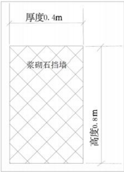
挡土保水岸墙断面示意图
