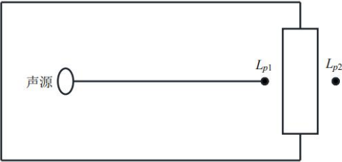
图 4 室内声源等效为室外声源图例
