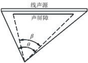
图2 受声点与线声源两端连接线的夹角（遮蔽角）
